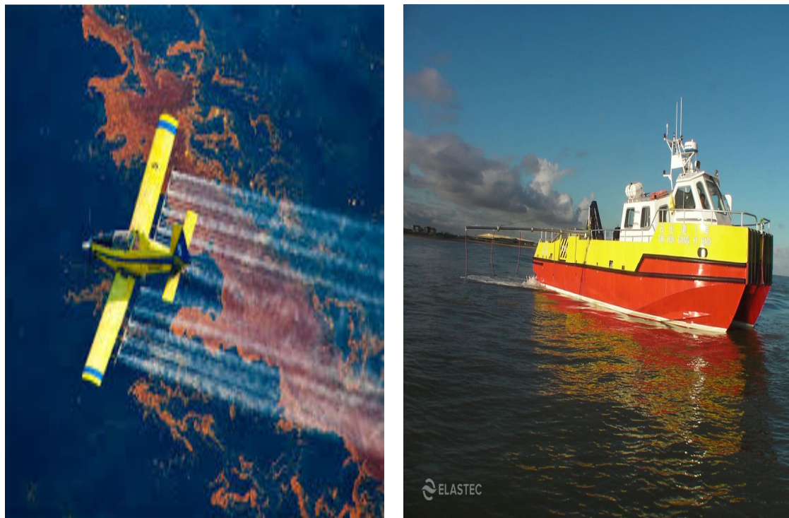
Σχήμα 14. Τρόποι χρήσης διασκορπιστήκαν μέσων [Πηγή: https://www.emaze.com , https://www.elastec.com/products/ ]
