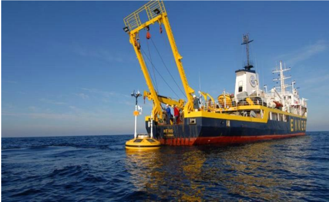
Εγκατάσταση Πλατφόρμας SEAWATCH WAVESCAN
