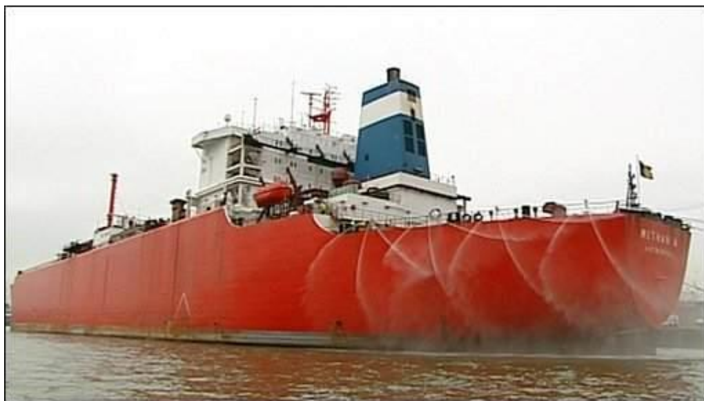
Εικόνα 24: Χρήση κανονιών νερού με σκοπό την απώθηση των πειρατών
