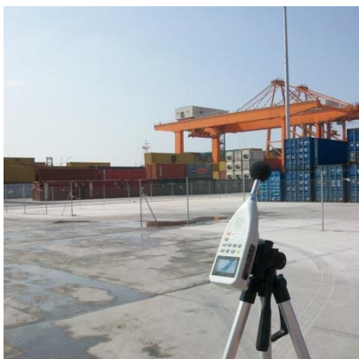
Εικόνα: Μετρήσεις θορύβου σε χώρο στοιβασίας εμπορευματοκιβωτίων.
