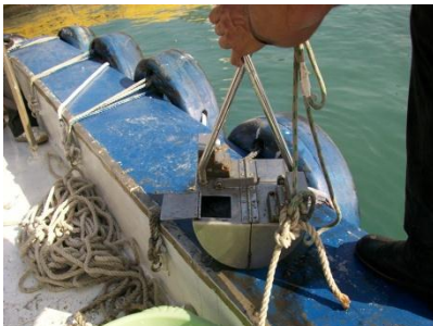
Εικόνα πάνω δεξιά: Λήψη δειγμάτων επιφανειακού θαλασσινού νερού προς εξέταση.
