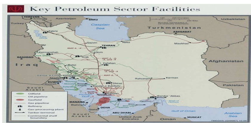
Εικόνα 3.1.3: Χάρτης κοιτασμάτων και υποδομών επεξεργασίας και μεταφοράς πετρελαίου και φυσικού αερίου του Ιράν.
