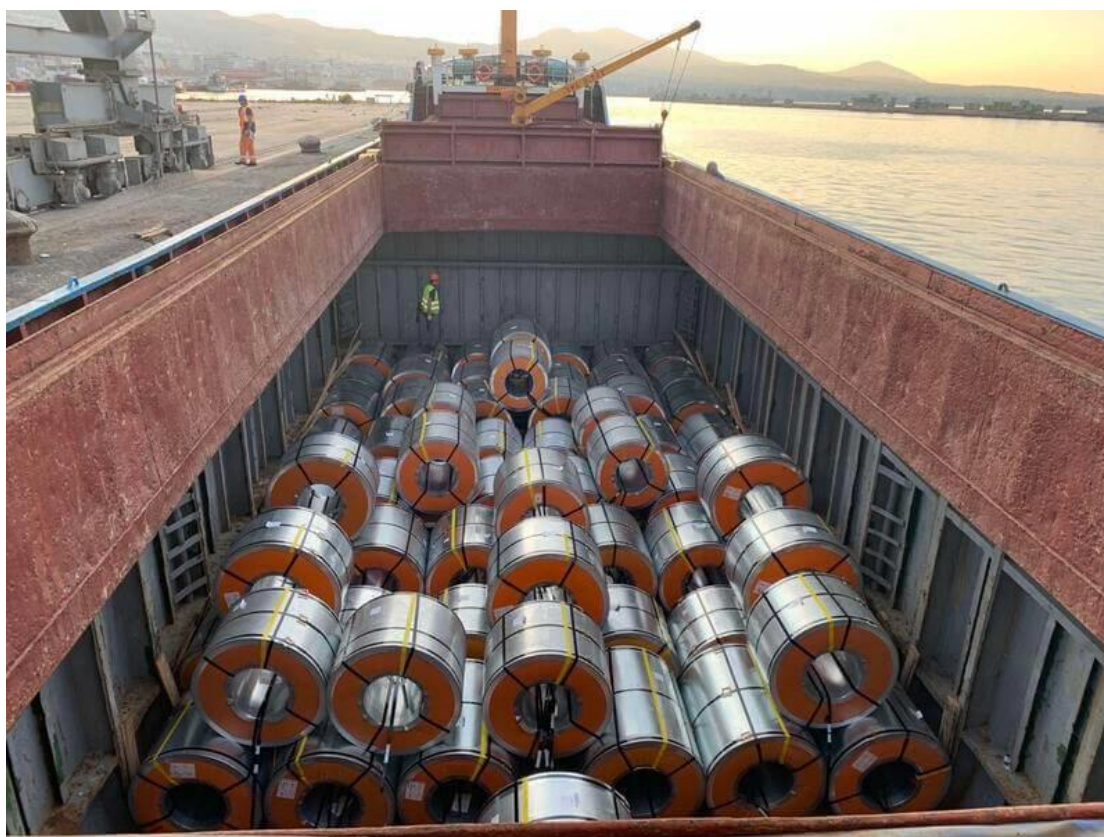
Εικόνα 6: Αμπάρι φορτωμένο με συσκευασμένα ρολά χάλυβα
