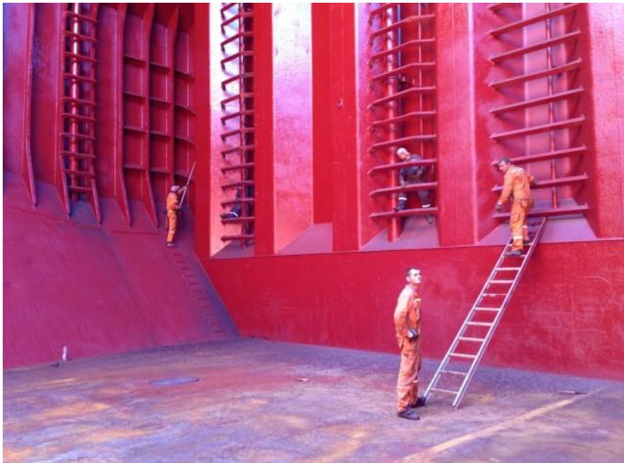
Αμπάρι καθαρό, στεγνό και βαμμένο κάνοντας τελευταίες λεπτομέρειες.
