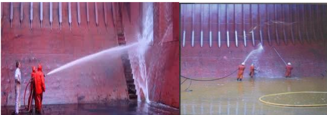
Πλύσιμο αμπαριού με μάνικα και τρίψιμο επιφανιών σε προηγούμενο φορτίο
