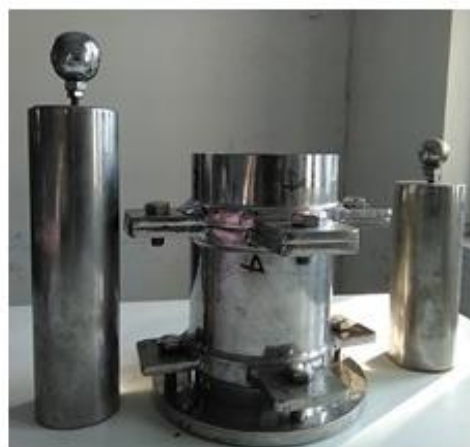
Εικ.3.8: Δοκιμή Proctor / Fagerberg
