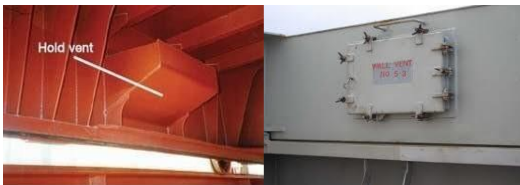
Εικ.1.11: Σύστημα Φυσικού εξαερισμού ενσωματωμένο στα καλύμματα στομίων κύτους
