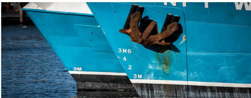
Εικόνα 11. Διάβρωση άγκυρας και γάστρας πλοίου
