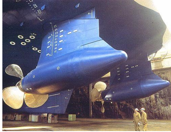
Εικόνα 13: Προπέλες μεταβλητου-κινητου μέρους έως και 180°
