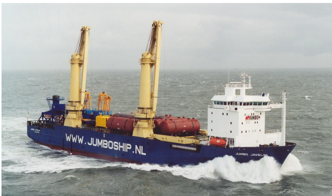
Εικ. 11: Γενικό φορτηγό πλοίο μεταφοράς βαρέων φορτίων, Heavy Lift Vessel
