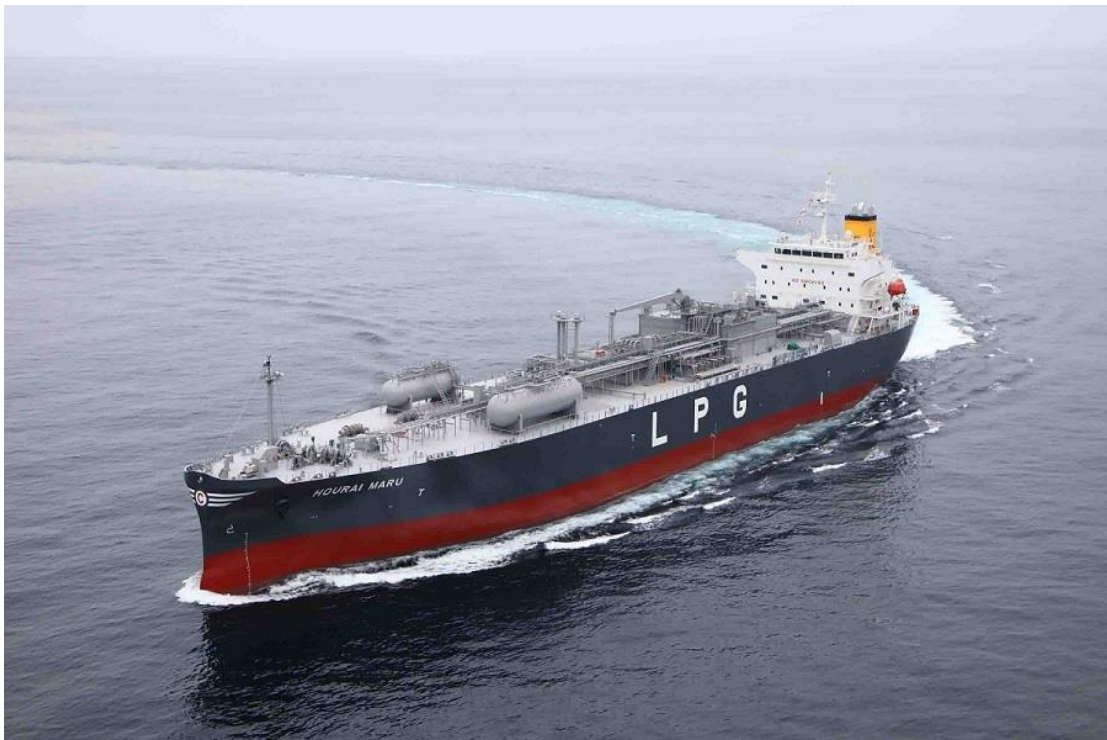
Εικ. 21: Πλοίο Μεταφοράς Υγροποιημένων Αερίων L.P.G.
