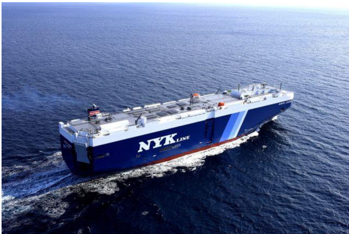
Εικ. 18: Πλοίο Roll-On/Roll-Off
