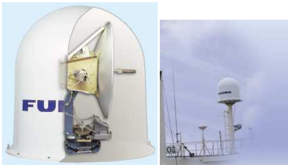
Φωτογραφία 7 : Απεικόνιση εσωτερικού κεραίας (Δεξιά). Τοποθέτηση στην κόντρα γέφυρα του πλοίου (Αριστερά )
