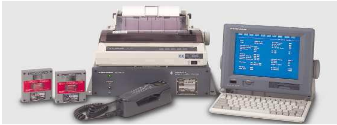
Φωτογραφία 8 : Σχεδιασμένα σύμφωνα με τις απαιτήσεις της Δ.Σ. SOLAS για το GMDSS, τα "κόκκινα" πλήκτρα ενεργοποιούν άμεσο συναγερμό κινδύνου και κινητοποίηση των κέντρων διάσωσης της ξηράς.
