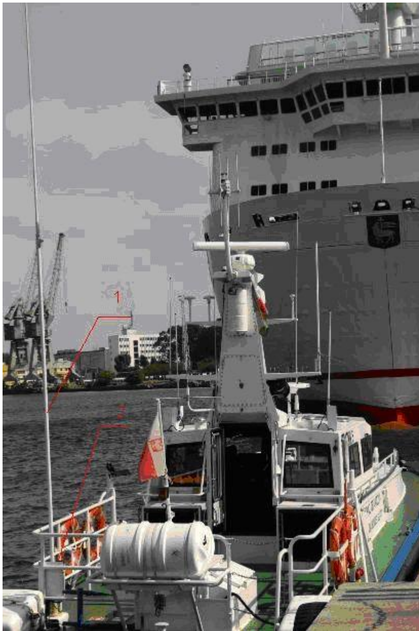
Φωτογραφία 4 : Παράδειγμα τοποθέτησης κεραία στο STRAZNIK 5
