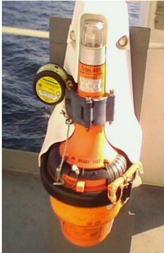
Φωτογραφία 4 : Απεικόνιση εσωτερικού συσκευής (Δεξιά) Απεικόνιση συσκευής και επίδειξη υδροστατικής βαλβίδας (Αριστερά)
