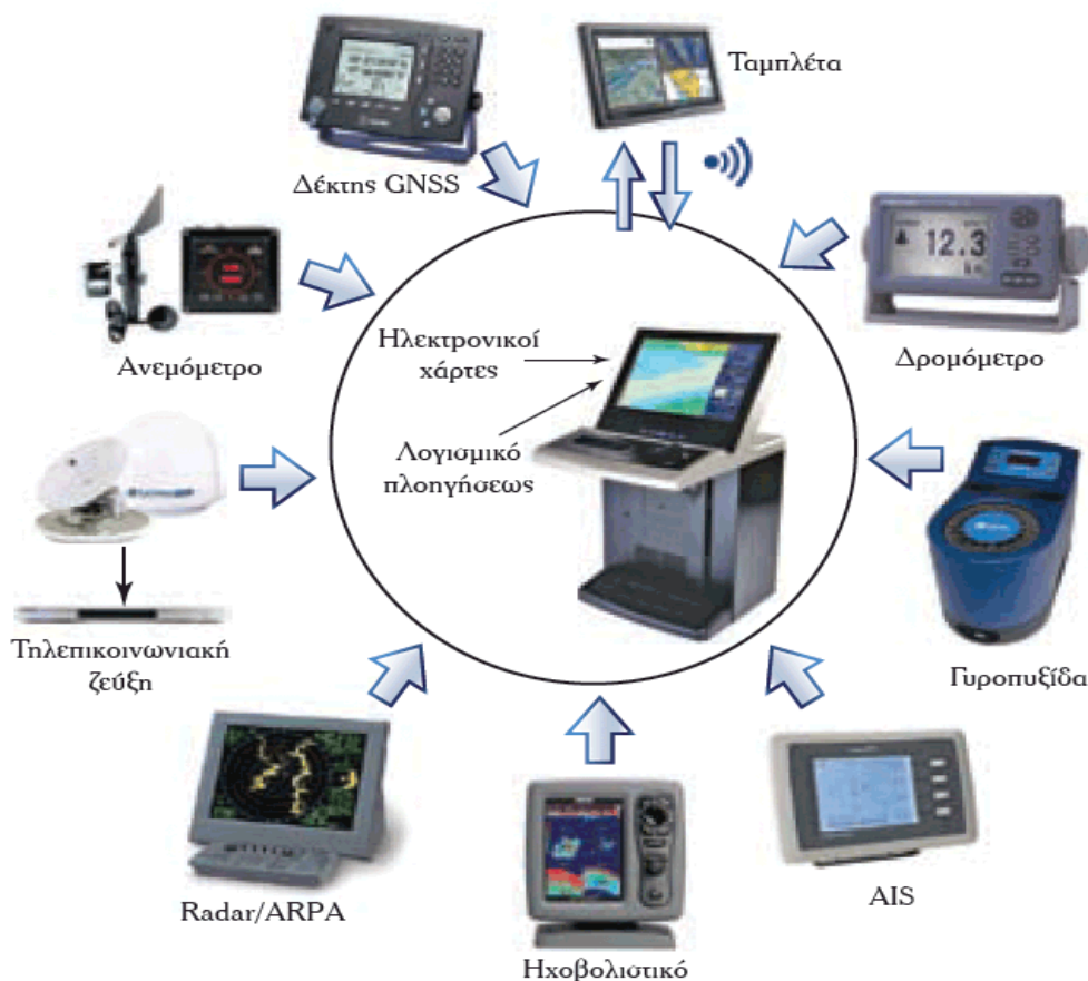
Εικόνα 20: Όργανα, αισθητήρες και συστήματα προσδιορισμού θέσεως συγκροτούν το ECDIS
