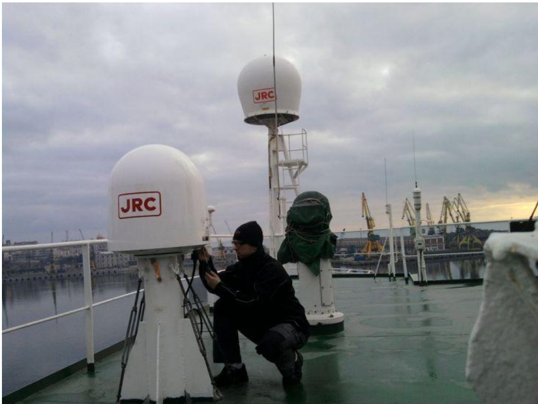
Εικόνα 3. Κόντρα γέφυρα- κεραία broadband
