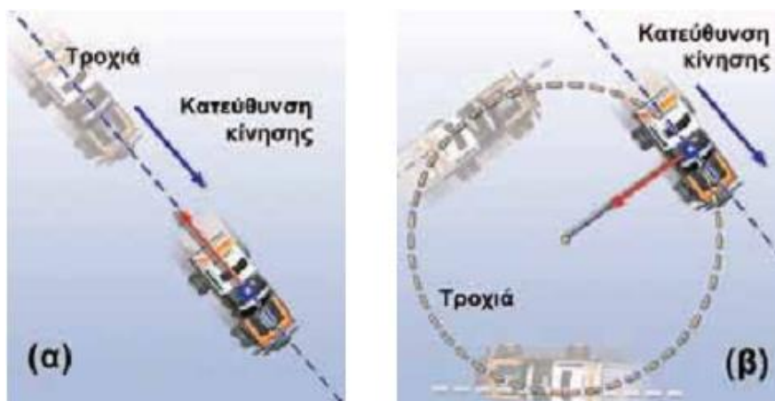
Εικόνα 7.6.2 - (α) Η δύναμη είναι αντίθετη με την κατεύθυνση της κίνησης. Το σώμα σταματά. (β) Η δύναμη είναι κάθετη στην κατεύθυνση της κίνησης. Το σώμα κινείται κυκλικά.
