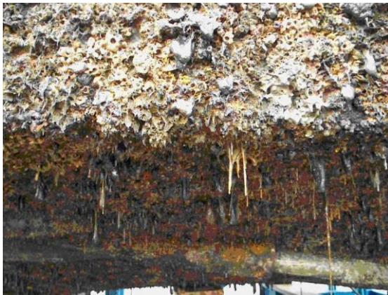
Διάβρωση επιφάνειας πλοίου
