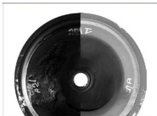
Σύγκριση βαλβίδας ολίσθησης καυσίμου πριν και μετά την τροποποίηση
