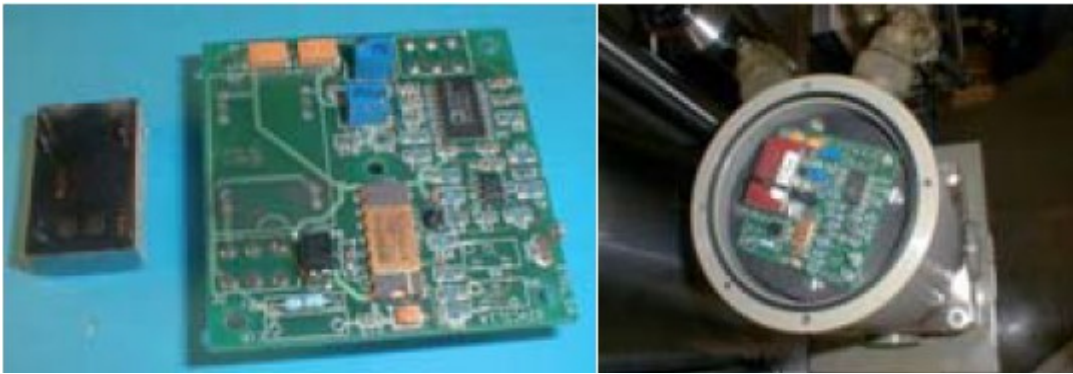
Εικόνα 14: Βαλβίδα ELFI, μετατροπέας DC-DC που αποκολλήθηκε λόγω δονήσεων στην πλακέτα τυπωμένου κυκλώματος
