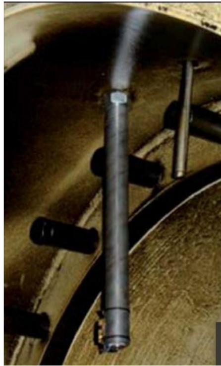
Εικόνα 20: Αισθητήρας σταγονιδίων νερού
