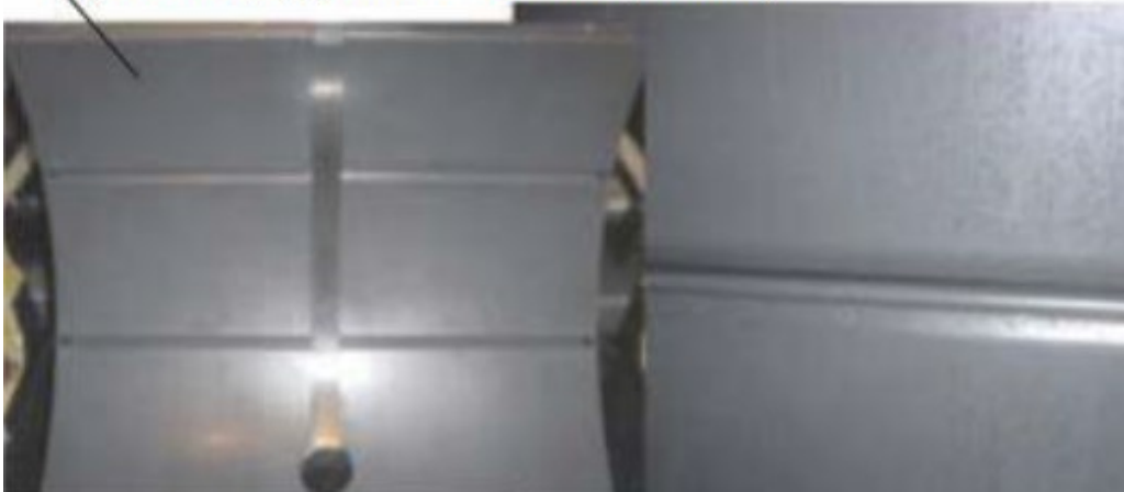
Εικ. 24: Συνθετική επίστρωση στο φολέα χιτωνίου εδράνου ολίσθησης AlSn40
