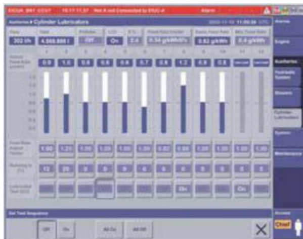
Εικόνα 5A: Παράδειγμα συστήματος ενσωμάτωσης:μηχανήςAlpha Lubricator
