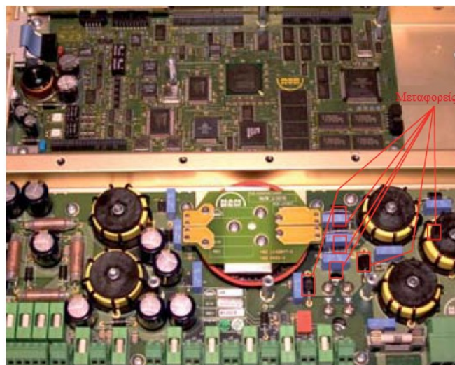
Εικ. 34: Αποτυχία απομόνωσης πλακέτας ρυθμιστή πολλαπλών χρήσεων ( Power Filter Board)
