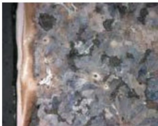
Εικόνα 14: Ελατήριο εμβόλου με «άσπρη στρώση»
