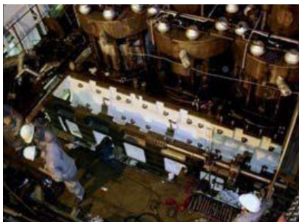
Εικ. 33: Αλλαγή δύο ραγισμένων τμημάτων περιβλήματος εκκεντροφόρου κυλίνδρου
