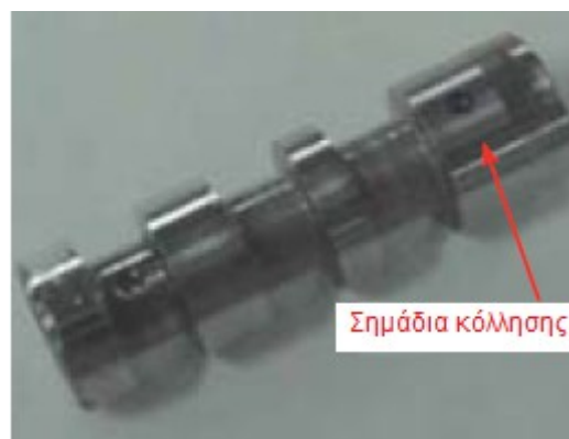
Εικ. 17: Βαλβίδα ELVA, που κολλάει στο πηνίο βαλβίδας υψηλής πίεσης
