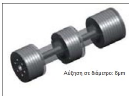
Εικ. 22: Βαλβίδα FIVA, αύξηση του κύριου πηνίου
