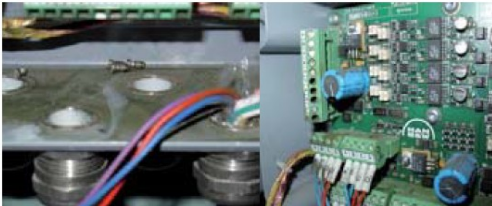
Εικόνα 36: PCB, μεταλλική σκόνη από χαλαρές (μη χρησιμοποιούμενες) βίδες
