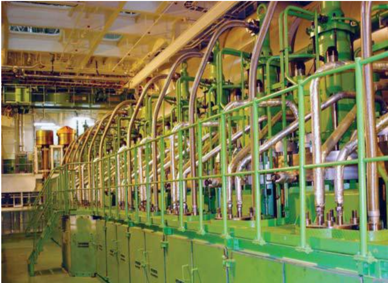
Εικόνα. 1: Μηχανή 12K98ME εγκατεστημένη σε πλοίο μεταφοράς εμπορευματοκιβωτίων.
