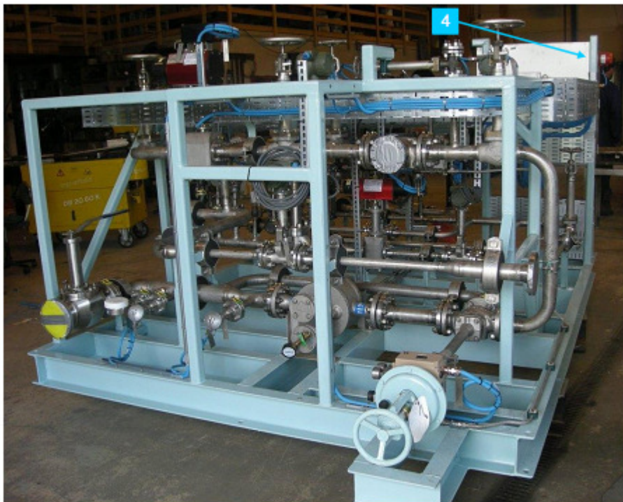
ΣΧΗΜΑ: LNG skid unit
