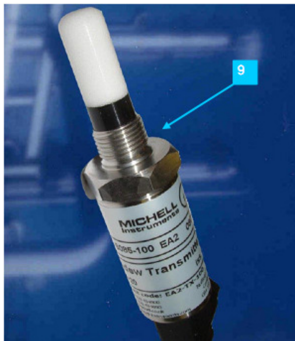
ΣΧΗΜΑ: Dew Point transmitter (πομπός θερμοκρασίας δρόσου)
