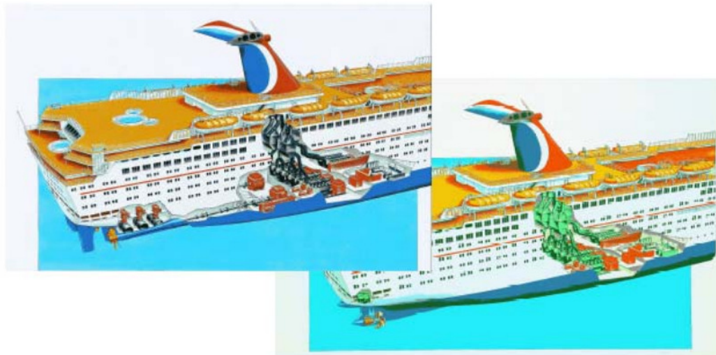
Σχήμα 3.3 Κρουαζιερόπλοιο “M/S Elation” με azipod (κάτω δεξιά) με σημαντικό ελεύθερο χώρο.
