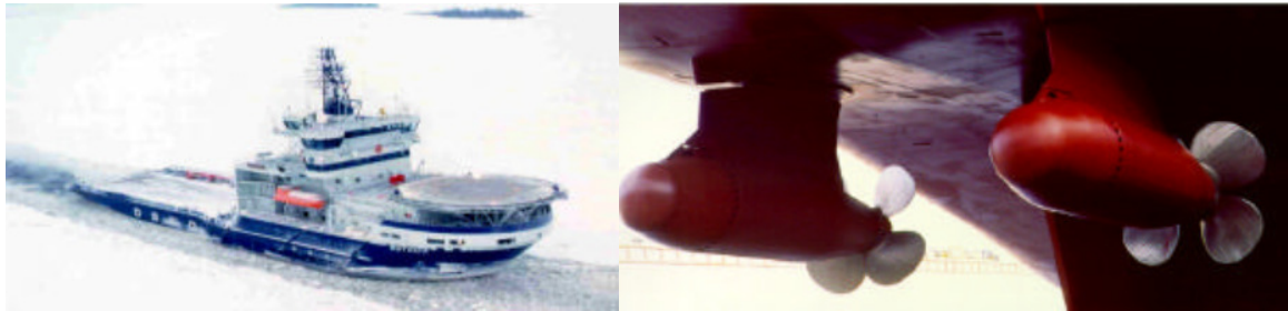
ΣΧ. 2.5: "M / S BOTNICA", παγοθραυστικό το οποίο χρησιμεύει ως ένα σκάφος εφοδιασμού σε θερινή περίοδο, που είναι εξοπλισμένα με Azipod (αζιμούθιο) πρόωσης.
