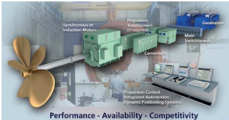
Σχήμα 3.12 Σύστημα ηλεκτροπρόωσης της Converteam.
