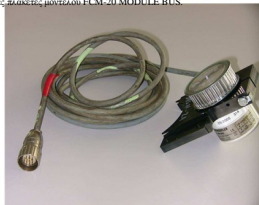
Ο αισθητήρας γωνίας στροφάλου με το σήμα που κ το καλώδιο μεταδίδει ψηφιακό σήματος.
