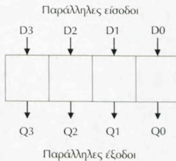
Σχήμα 7.3.9 Σχηματικό διάγραμμα καταχωρητή ολίσθησης PIPO 4-bits
