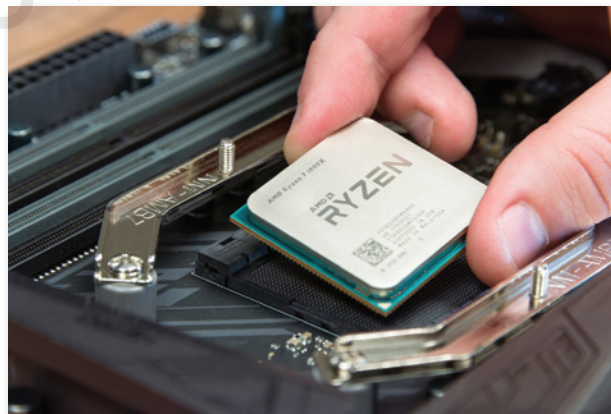
Σχ. 1.13 Τοποθέτηση ΚΜΕ επάνω στην μητρική πλακέτα.
