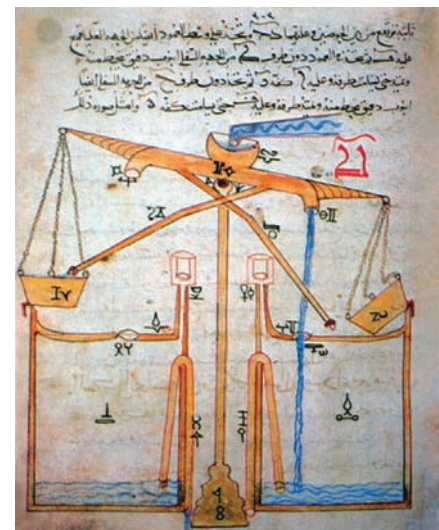
Σχ. 10.1γ. Διάγραμμα αντλήσεως, από το βιβλίο του Al-Jazari: The Book of Knowledge of Ingenious Mechanical Devices (1206).
