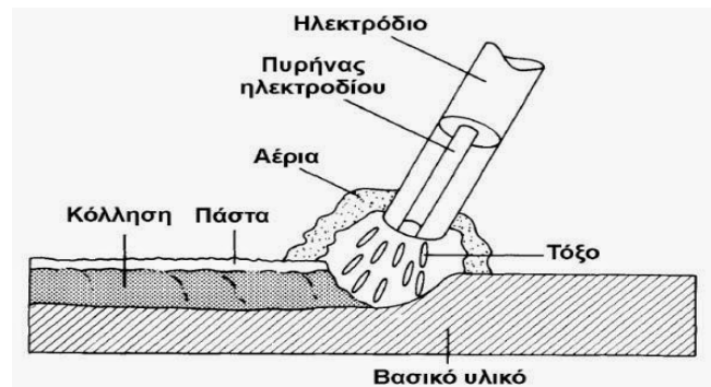
Εικ. 4. Τήξη ηλεκτροδίου MMA
