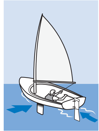
Σχ. 5.75 Ο συνδυασμός των δυνάμεων έχει ως αποτέλεσμα την κίνηση του σκάφους κατά μήκος του άξονά του
