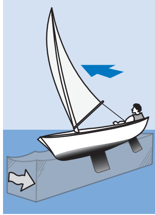
Σχ. 5.74 Η καρίνα του σκάφους προβάλλει αντίσταση στην πλάγια κίνηση
