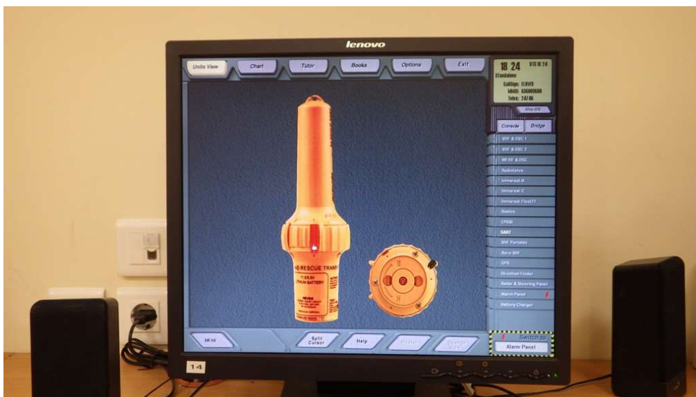
Εικόνα 1: Προσομοιωτής GMDSS Σχολής Πλοιάρχων Ακαδημίας Εμπορικού Ναυτικού Ασπροπύργου, συσκευή αναμεταδότη SART (UHF – 9GHz) (Πηγή: Προσωπικό αρχείο)
