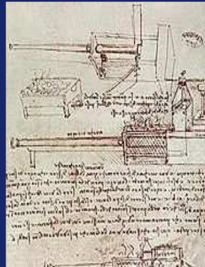
Σχέδιο του Λεονάρντο ντα Βίντσι για ένα κανόνι ατμού το οποίο αποδίδεται στον Αρχιμήδη.
