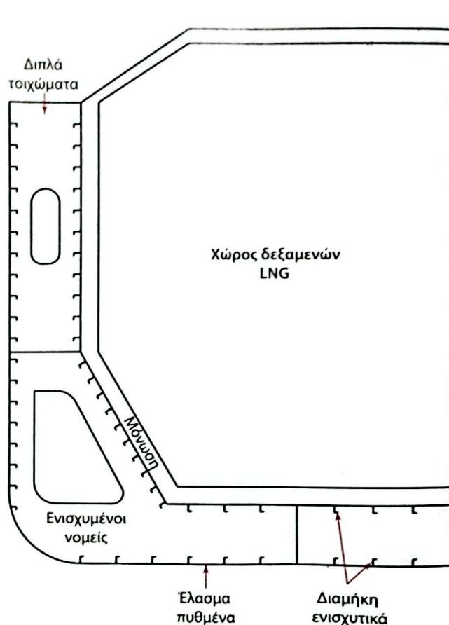
Σχ. 9.11 Ημιτομή πλοίου LNG με πολυγωνικές δεξαμενές
