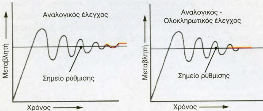
Σχήμα 6.8 Ο τρόπος διακύμανσης της τιμής της ελεγχόμενης παραμέτρου συναρτήσει του χρόνου, στο αναλογικό σύστημα (P) ελέγχου και στο αναλογικό-ολοκληρωτικό (PI). Προσέξτε ποια είναι η διαφορά που σημειώνεται με κόκκινο χρώμα.
