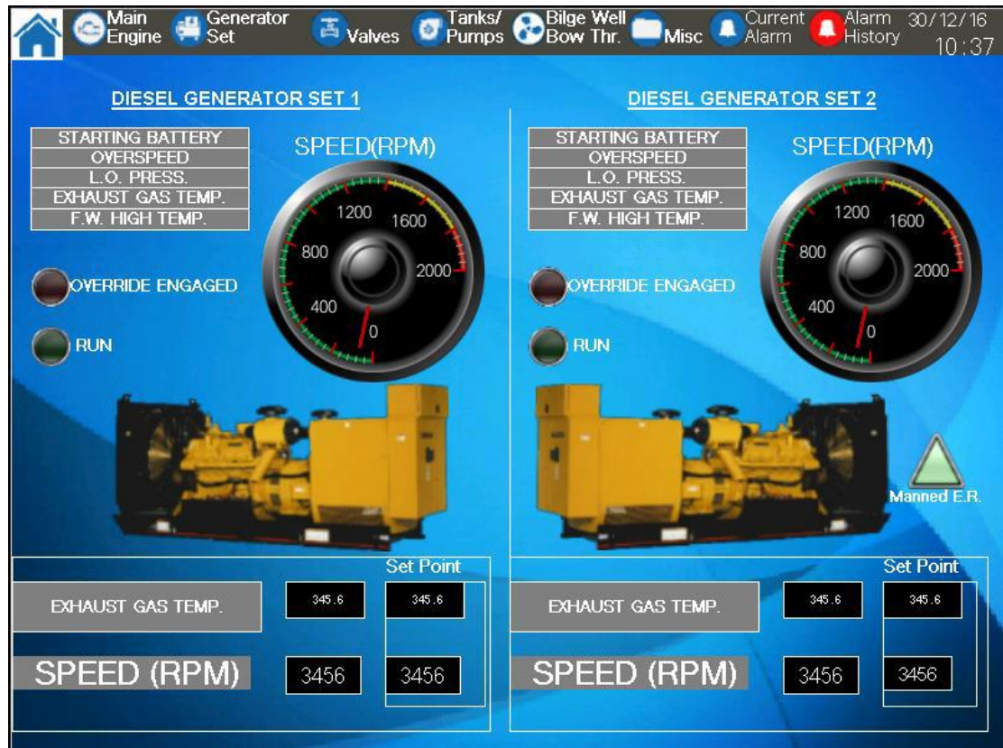
Εικόνα 7 σήματα από γεννήτριες - από πρόγραμμα HMI γεννήτριας Πηγή UTECO ABBE
