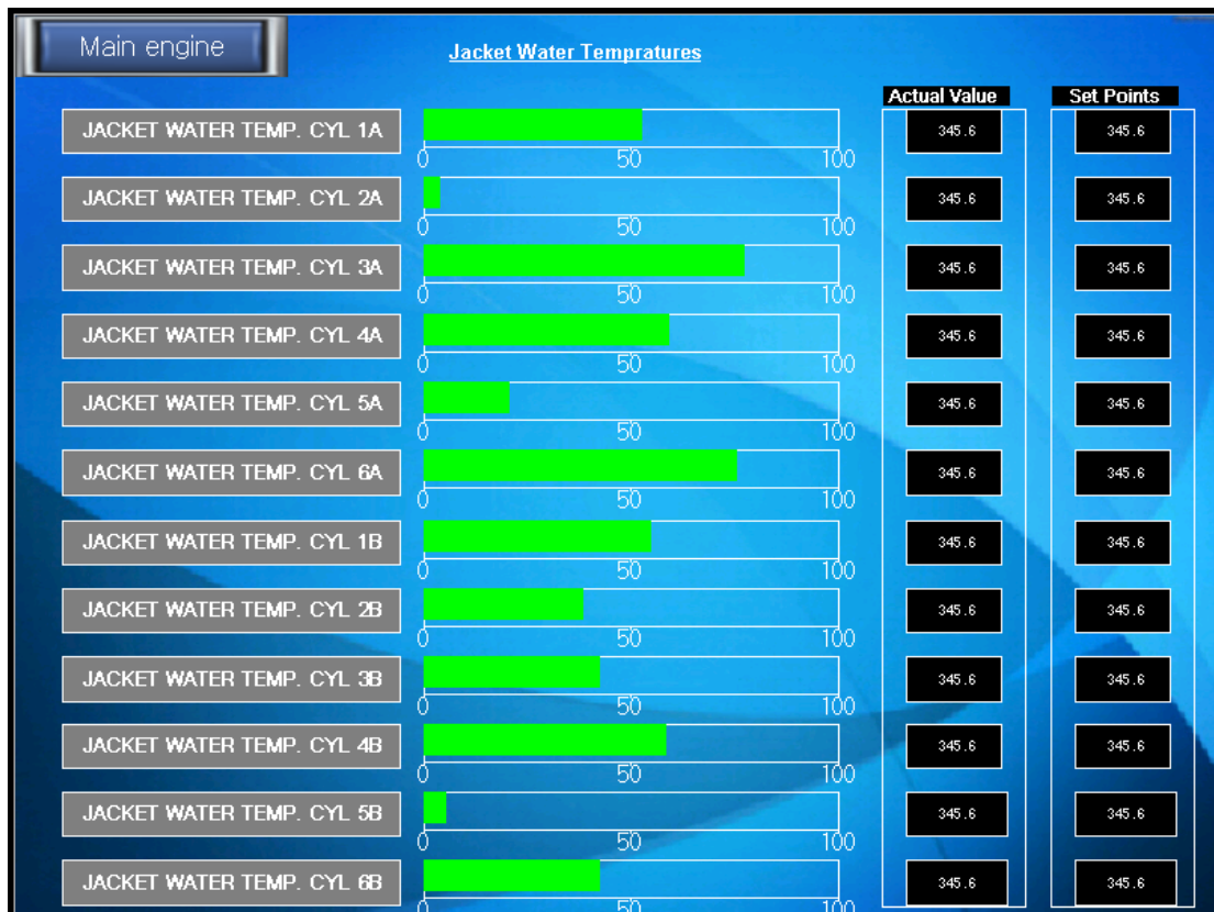
Εικόνα 5 κύρια μηχανή θερμοκρασίες νερού - από πρόγραμμα HMI γεννήτριας Πηγή UTECO ABBE
