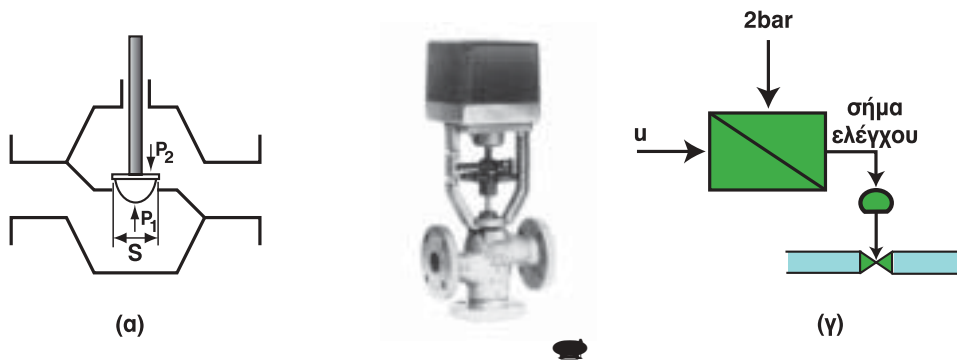
Σχήμα 5.17: Τομή μονοθέσιας αναλογικής βαλβίδας (α), εμπορική μορφή (β), σύμβολο (γ).
