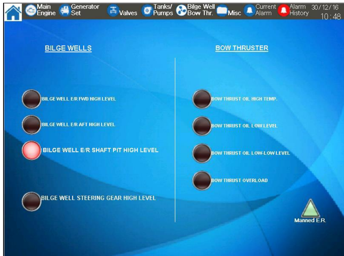
Εικόνα 10 από σήματα στάθμης - από πρόγραμμα HMI αισθητήρες στάθμης στα ύφαλα του πλοίου καθώς και έλικα
