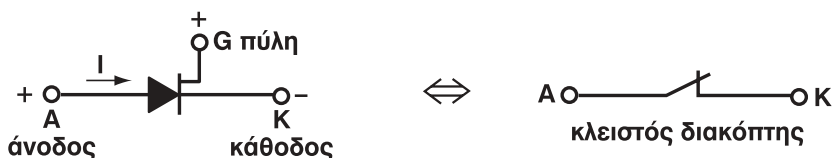
Σχήμα 5.5.8: Θυρίστορ ορθά πολωμένο.
