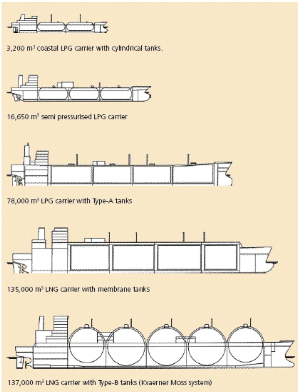
**Figure 1.1 (E) TYPES OF GAS TANKERS**
