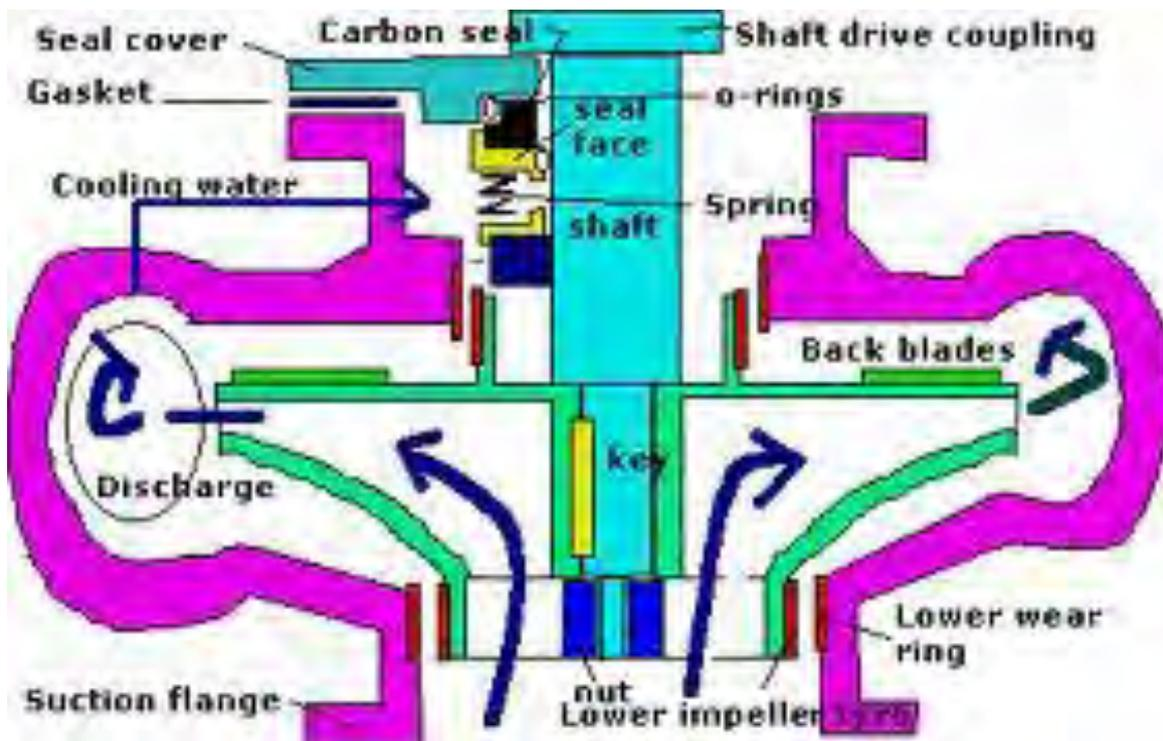
Figure 2.3 (H) CENTRIFUGAL PUMP
