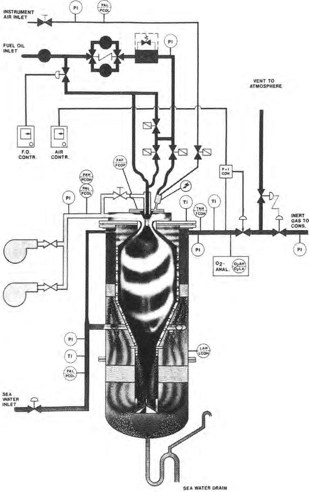
Figure 2.5 (A) AN INERT GAS GENERATOR
