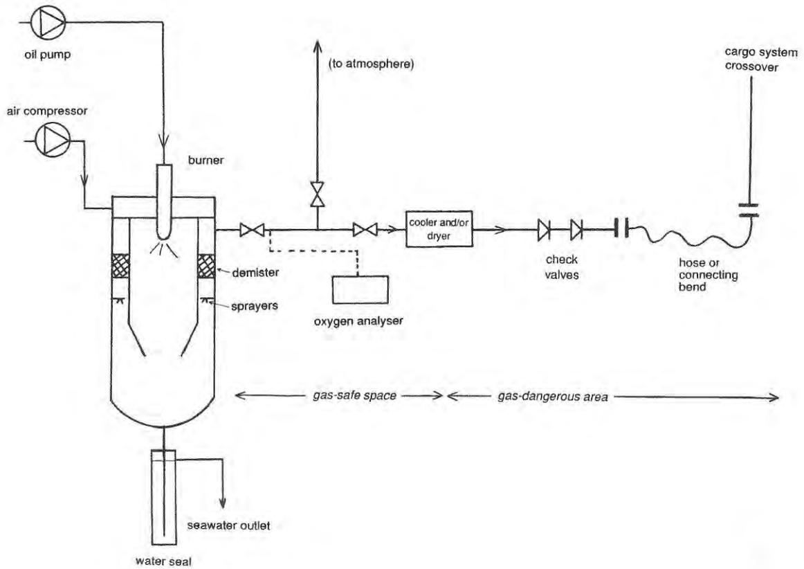
**Figure 2.5 (B) SCHEMATIC DIAGRAM OF AN INERT GAS GENERATOR SYSTEM**
