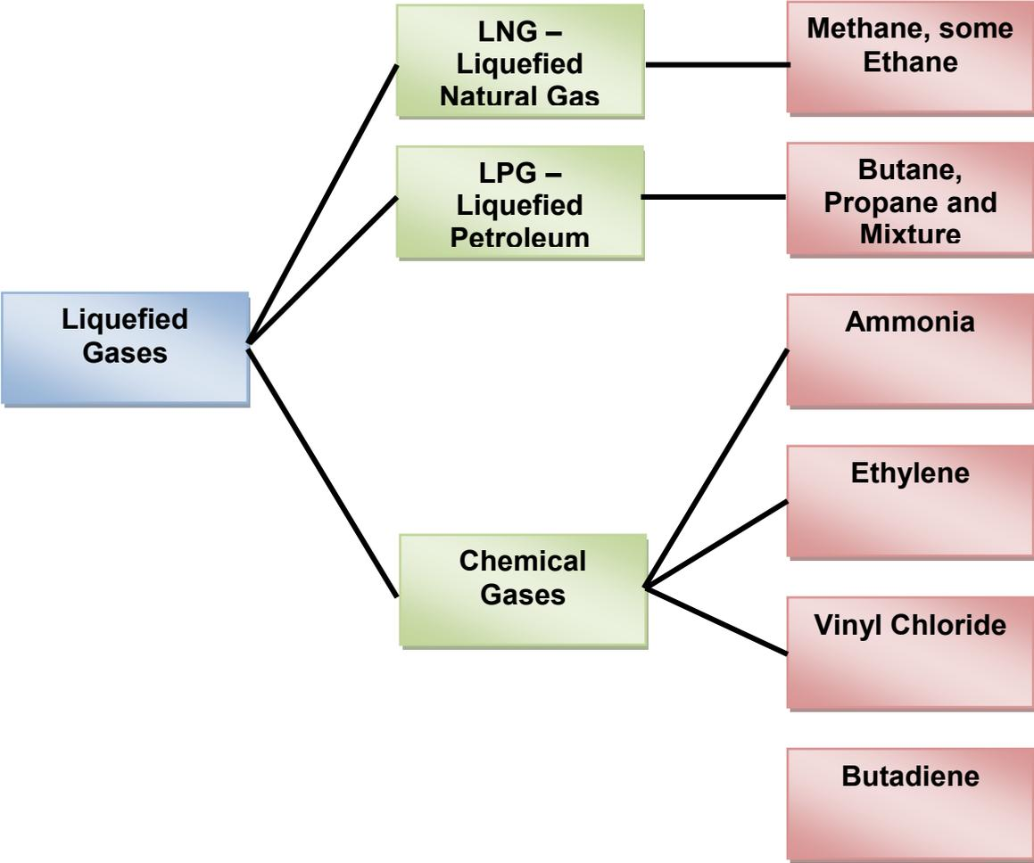
Figure 1.1 (D) TYPES OF LIQUEFIED GASES
