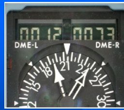
Φωτογραφία 4.2: Ομοίως με την παραπάνω φωτογραφία, η απόσταση του αεροσκάφους παρουσιάζεται και στο όργανο DDMMI του αεροσκάφους. Το DME-L, που είναι το #1 σύστημα του αεροσκάφους, μας δείχνει την απόσταση από το σταθμό VOR1 SPA και το DME-R, που είναι το #2 σύστημα του αεροσκάφους, μας δείχνει την απόσταση από το σταθμό VOR2 ATV.
