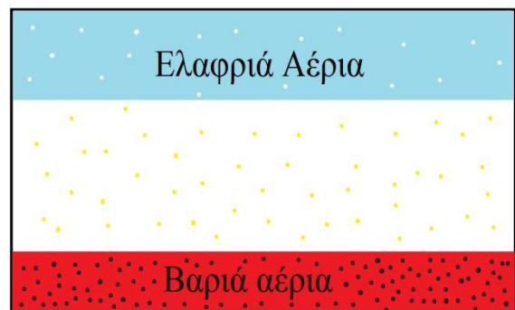
Εικόνα 26: Κλειστή δεξαμενή αερίου
