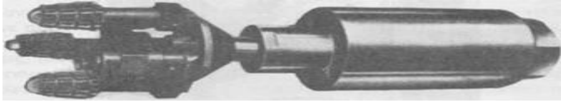
Εικόνα 6: Υδραυλικός κινητήρας με κόπτη προσαρμοσμένος απευθείας πάνω στον κινητήριο άξονα για ευθείς αυλούς
