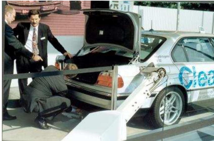
Σωλήνας ανεφοδιασμού με υγρό υδρογόνο στη πίστα δοκιμών της BMW.
