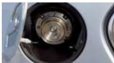
Βαλβίδα ασφαλείας σε ντεπόζιτο υγρού υδρογόνου.
