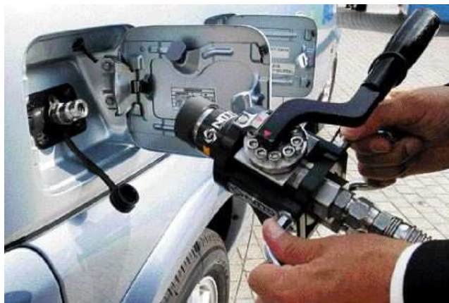
Σωλήνας πλήρωσης για ανεφοδιασμό με υγρό υδρογόνο.
