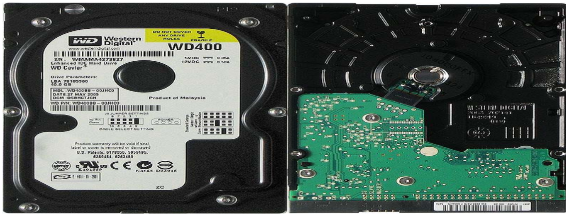
Εικόνα 3. Η Πάνω και η Κάτω όψη ενός σκληρού Δίσκου
