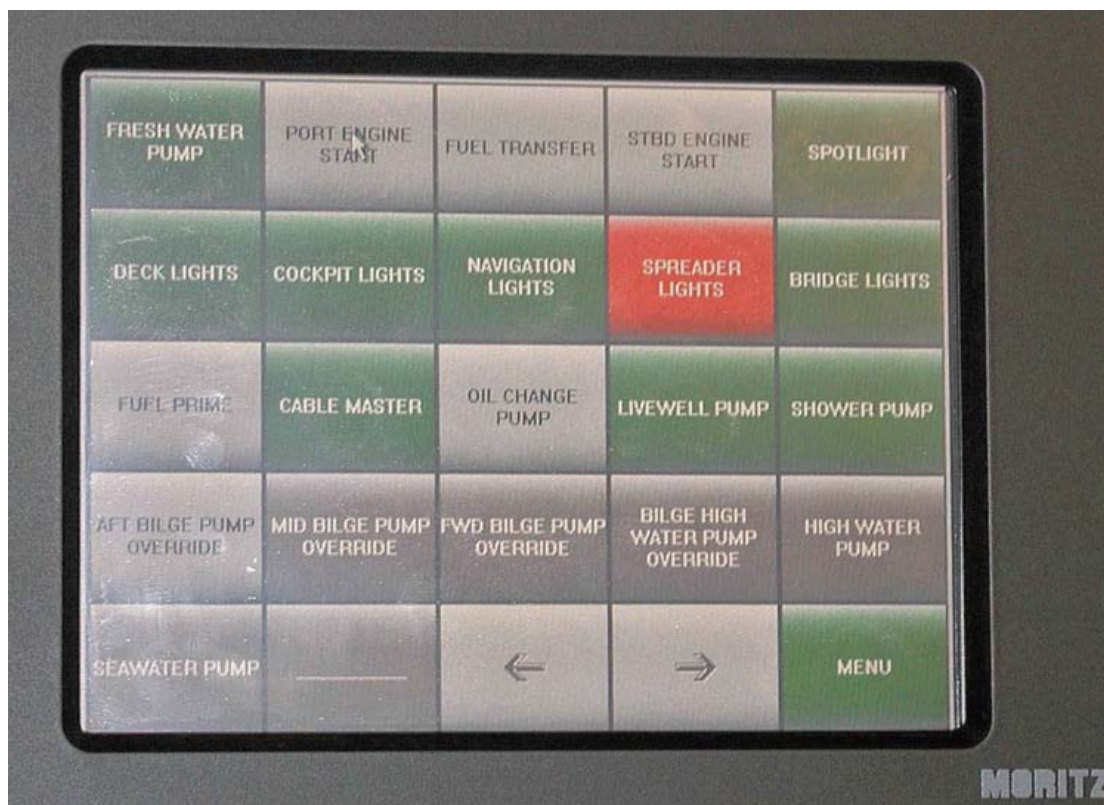
Εικόνα 4. Κεντρικό monitor του Control Panel. Αυτή είναι μια ηλεκτρονική οθόνη touchscreen που πάνω της είναι συνδεδεμένα όλα τα κυκλώματα.
