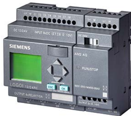
Εικόνα 4.3: PLC Siemens LOGO! 12/24RC με μονάδα επέκτασης.
