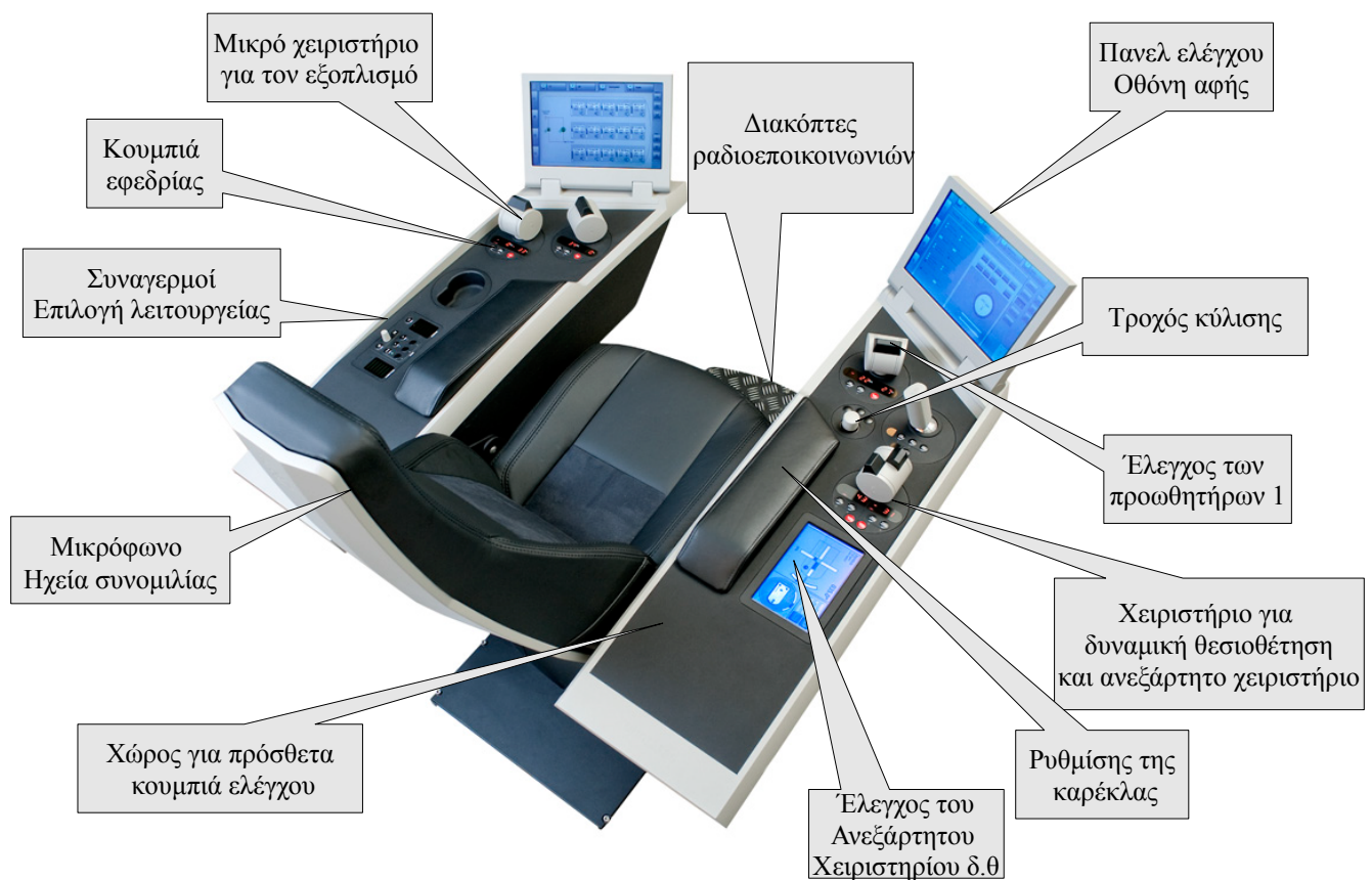
Εικόνα 26: Σύγχρονη διάταξη ελέγχου δυναμικής θεσιοθέτησης, κατασκευαστής kongsberg
