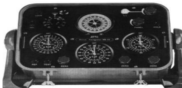
α. Παλιός δέκτης υπερβολικού συστήματος DECCA(δεκαετία 1950-1960)
