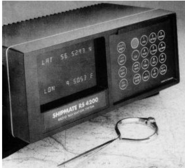
β. Νεότερος δέκτης συστήματος DECCA, με ψηφιακή οθόνη ενδείξεως γεωγραφικών συντεταγμένων [δεκαετία 1970-1980]
