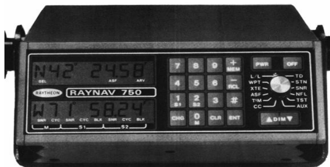
δ. Νεότερος δέκτης LORAN με ψηφιακή οθόνη ενδείξεως γεωγραφικών συντεταγμένων [δεκαετία 1970-1980]
