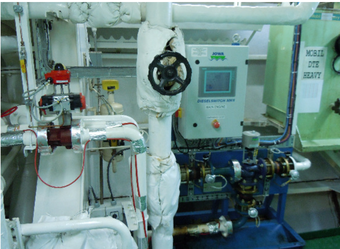
Εικόνα 5 – PLC για Fuel Management σε κρουαζιερόπλοιο [πηγή : http://www.jowatechnology.se/press-release-7297497 ]
