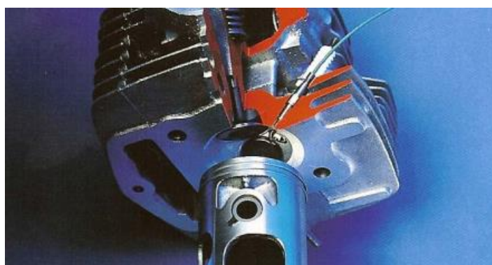
Εικόνα 4.6 Πιεζοηλεκτρικός αισθητήρας σε μηχανή μοτοσυκλέτας
