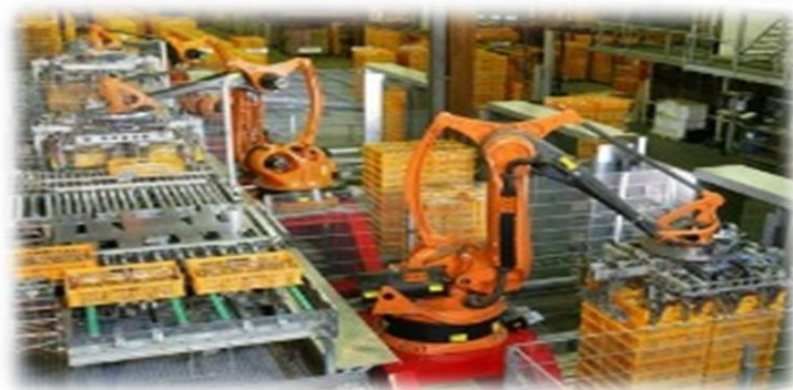
Εικόνα 1.1 (Βιομηχανικά ρομπότ σε μία πλήρως αυτοματοποιημένη μονάδα παραγωγής φαγητού)
