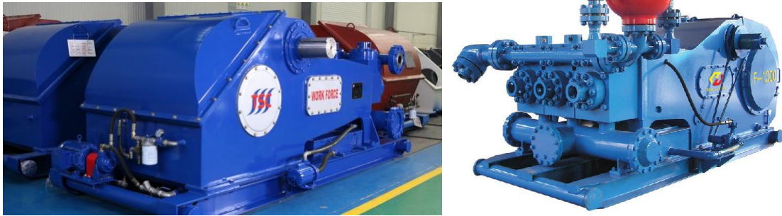
Εικόνα 3.10. Αντλίες δύο(αριστερά) και τριών κυλίνδρων (δεξιά)
