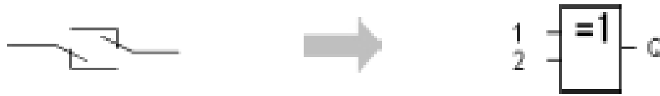
Εικόνα 4.5: Ταυτόχρονη αλλαγή κατάστασης επαφών → Σύμβολο LOGO:
