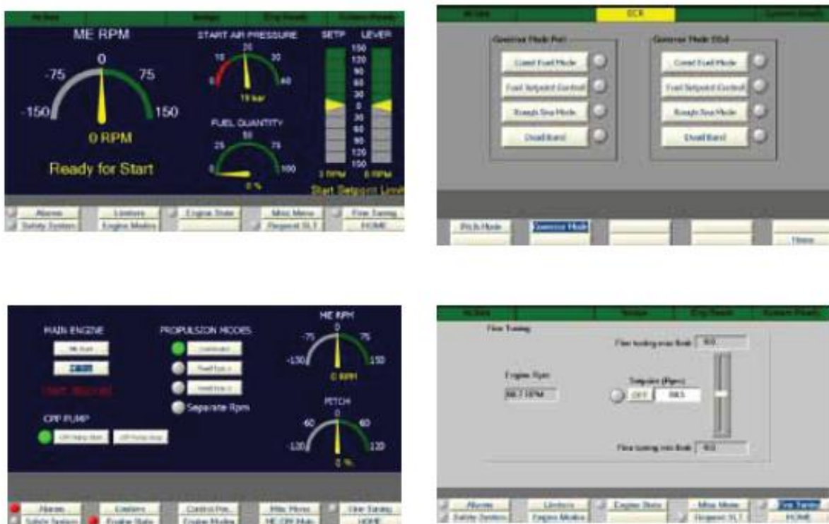
9. Εικόνα. :Παραδείγματα της οθόνης του control panel του Autochief C20
