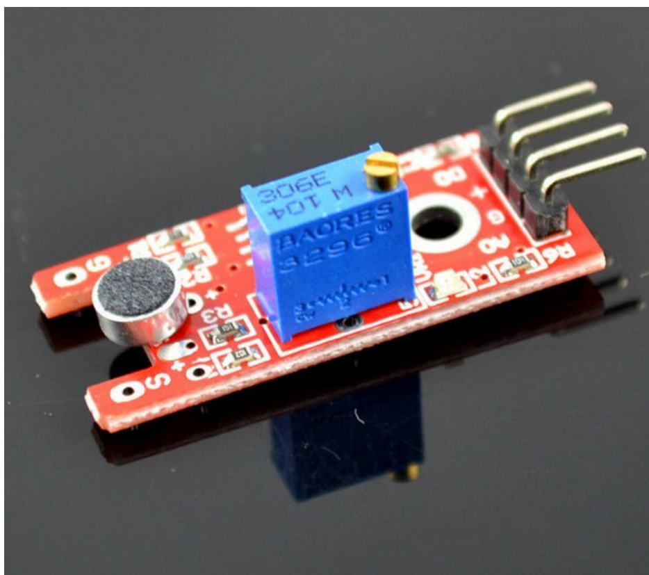
Εικόνα 3.9 : Μονάδα μικροφώνου για ανίχνευση ήχου
