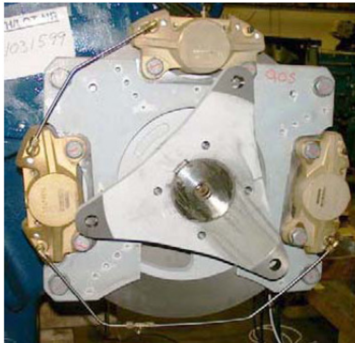
Φωτογραφία ολοκλήρου του συστήματος φρένου, τοποθετημένο
