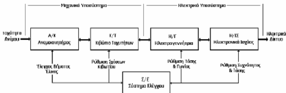
Διάγραμμα ροής σημάτων λειτουργίας και ελέγχου ανεμογεννήτριας
