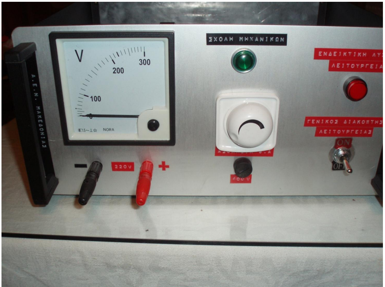
Εικόνα 5.6.4 Εξωτερική μορφή ροοστάτη , εικόνα ενδεικτικής λυχνίας λειτουργίας ,ενδεικτικός διακόπτης λειτουργίας, λυχνία μεταβολής τάσης και ασφάλεια διάταξης .
