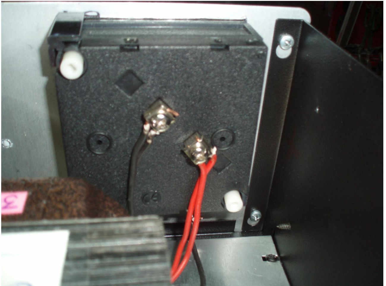
Εικόνα 5.6.4 Μετρητής volt από την πίσω πλευρά .
