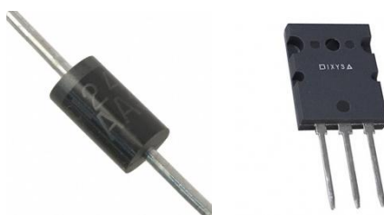
Εικόνα 2.3.3.1 - Αριστερά Δίοδος Schottky, δεξιά MOSFET.
