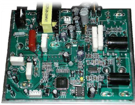
Εικόνα 0.3.2.4.1 – Inverter του κλιματιστικού.
