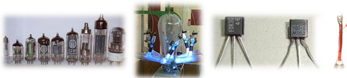
Εικόνα 0.2.1 - Vacuum tube diodes, Mercury-vapor rectifier, Solid-state diodes, Thyristor
