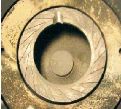
Εικόνα Νο. 1 - Θάλαμος καύσης κατασκευασμένος από κεραμικό υλικό.
