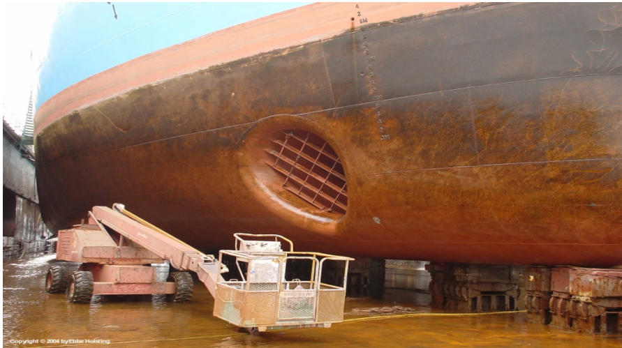
Εικόνα 22. Σκουριασμένος απωθητής λόγω έλλειψης συντήρησης
