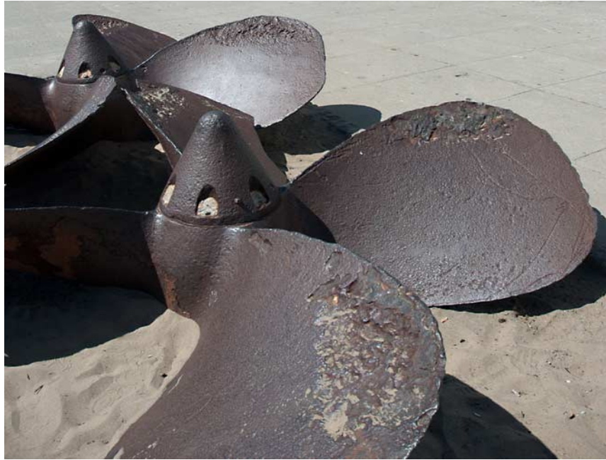
Εικόνα 14.Καταπονημένη προπέλα από σπηλαίωση
