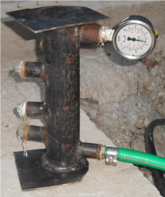
ΕΙΚΟΝΑ 3.13: ΔΟΚΙΜΗ ΒΑΣΗΣ (Β) ΣΤΑ 5bar
