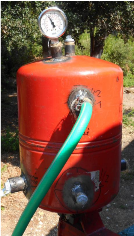
ΕΙΚΟΝΑ 3.9, 3.10: ΔΟΚΙΜΗ ΥΔΡΟΦΟΡΑΣ ΣΤΑ 5bar
