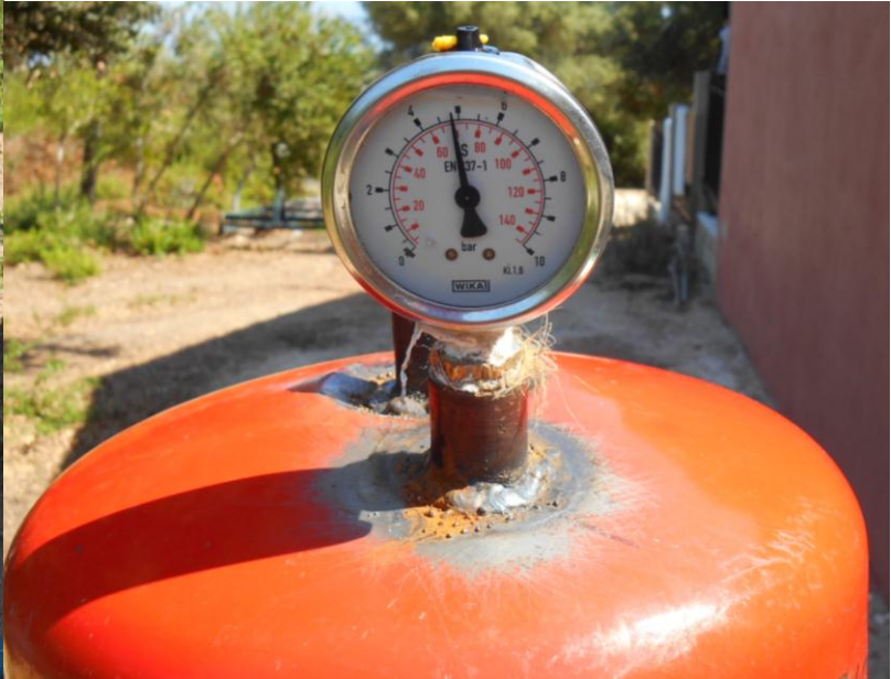
ΕΙΚΟΝΑ 3.9, 3.10: ΔΟΚΙΜΗ ΥΔΡΟΦΟΡΑΣ ΣΤΑ 5bar
